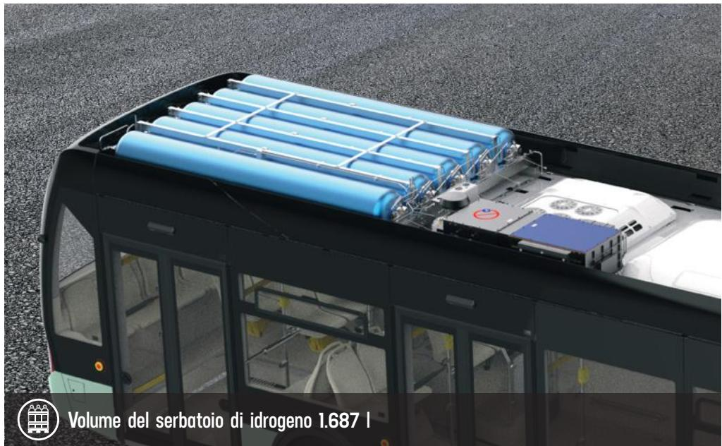
Volume del serbatoio di idrogeno 1.687 l
