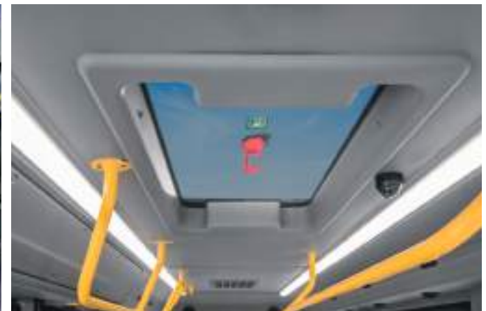
Botola elettrica sul tetto
